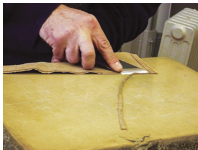
FIG. 20. Conservador da British Library chanfrando couro, durante demonstração de técnicas de reparos de encadernação. FOTO: ANA PAULA HIRATA TANAKA
